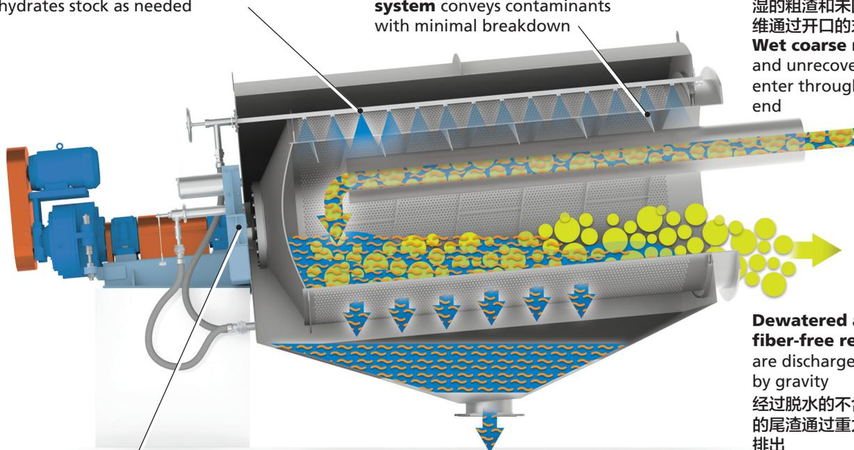
脱水后的不含纤维的尾渣通过重力作用被排出
